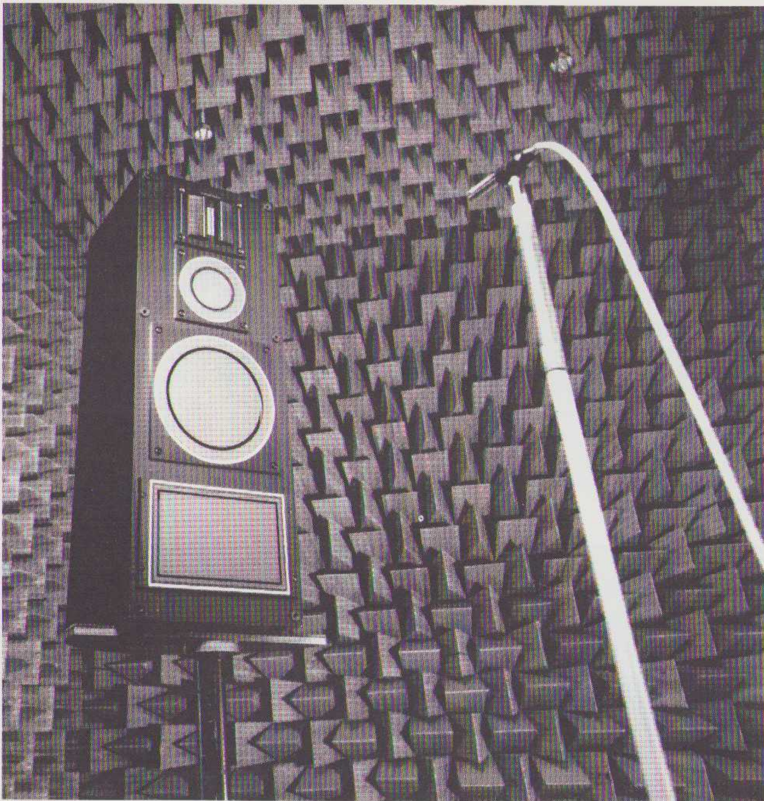
Proefmodel F9434 in meetopstelling (dode kamer). Midden en hoog in het midden gemonteerd.
